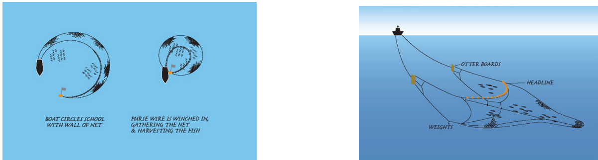
Figuur 7. Purse seine of pelagische trawler, de vismethoden om haring te vangen ( www.afma.gov.au ).
